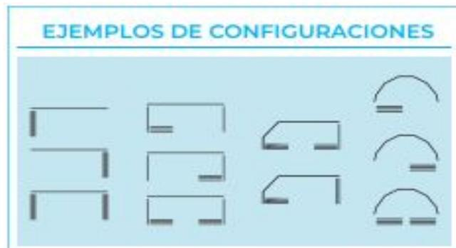
El nuevo sistema le permitirá deslizar las hojas por cualquier disposición geométrica, realizar aperturas exteriores/interiores, accionamientos interiores/exteriores, ramos fijos con posibilidad de limpieza, etc.
