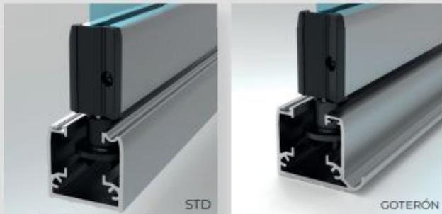
El perfil inferior en superficie junto con el perfil goterón, tienen como característica principal que, permiten una mejor evacuación de la humedad provocada por la condensación, drenándola hacia el exterior a través del perfil inferior.
